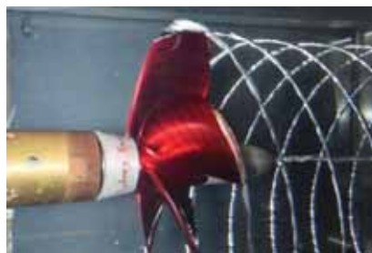
図 1. 2. 6 キャビテーション水槽の水中騒音計測
