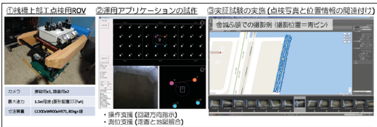
図 1. 3. 4 3 棧橋上部工点検用 ROV (左) と運用アプリケーション (中) および実証試験結果 (右)
