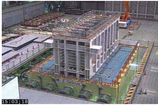
図 1. 3. 8 大型振動台「E-ディフェンス」
