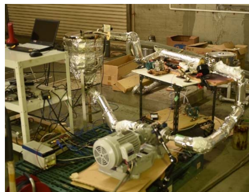
図 16 アスファルテン壁面付着評価のための回流試験
