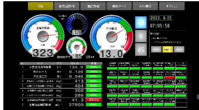
図 11 エンジン監視画面の例(299GT 貨物船)
