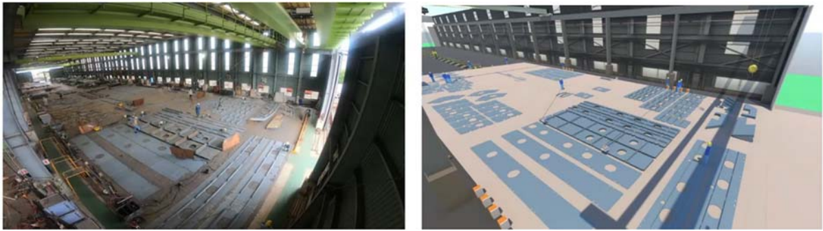
図7 小組立工程の建造シミュレーション(浅川造船株式会社) (左:実際の造船所の様子、右:建造シミュレータによる計算)
