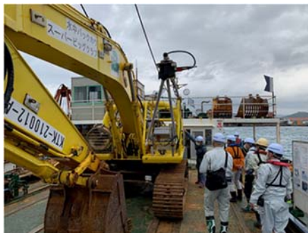
図 1.3.55 港湾工事や他工種作業(ダム排水口)における水中マシンガイダンスの利用
