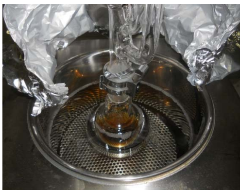
図 15 アスファルテン付着量評価のための SARA 解析
