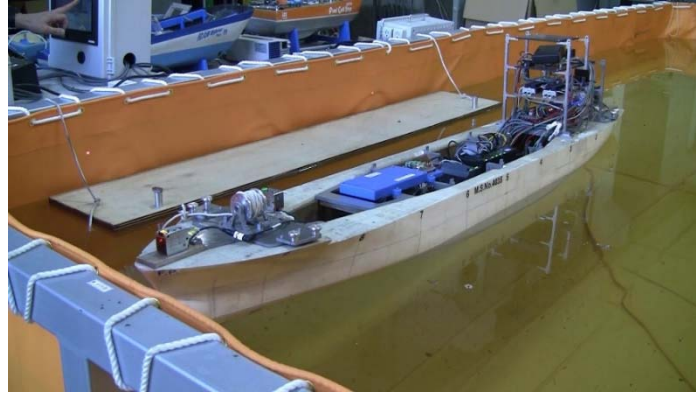
図7 499GT 模型船(全長 2m)
