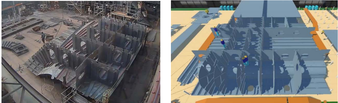
図8 大組立工程の建造シミュレーション(浅川造船株式会社) (左:実際の造船所の様子、右:建造シミュレータによる計算)
