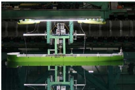
図19 実海域再現水槽での拘束模型試験
