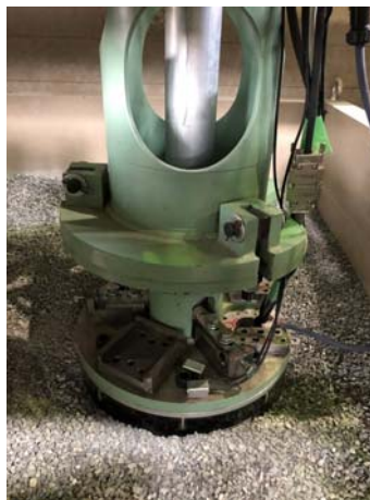
図 1.3.39 掘削マシンの貫入
