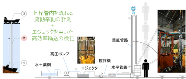
図 1.3.72 エマルジョン流動の実験
