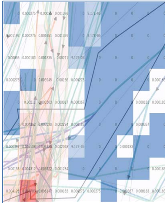
図 1.4.11 T02 セクターをセルに分割し、セル毎にレーダー航跡に基づいた MMBB の値(数値)とセルの色(赤:複雑性高、青:複雑性低)で表す複雑性の計算結果の例 レーダー航跡を重ね合わせており、局所的な交通流の密集が見られる。
