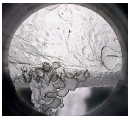
図 17 気液界面に生じたガスハイドレートの様子
