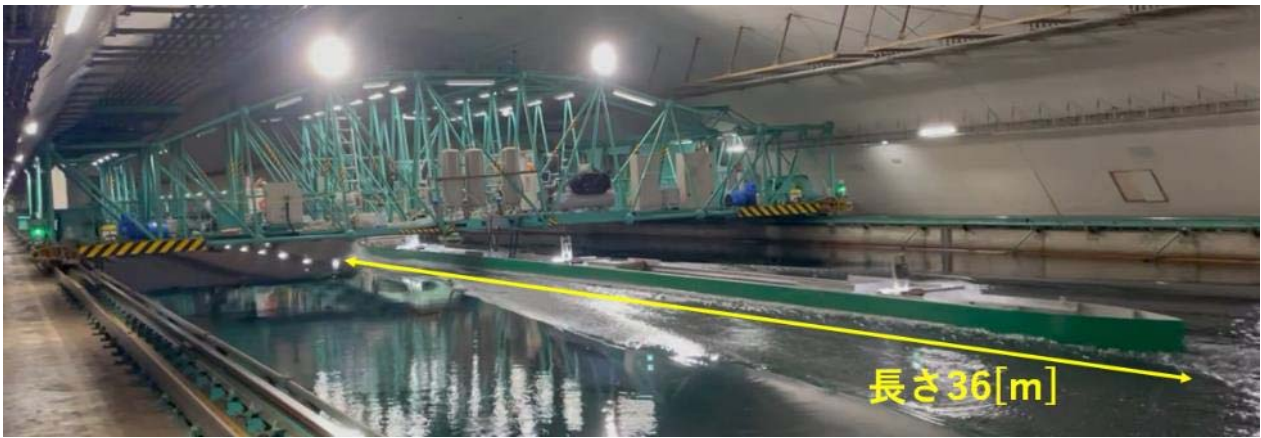
図 32 36m 長尺模型試験
