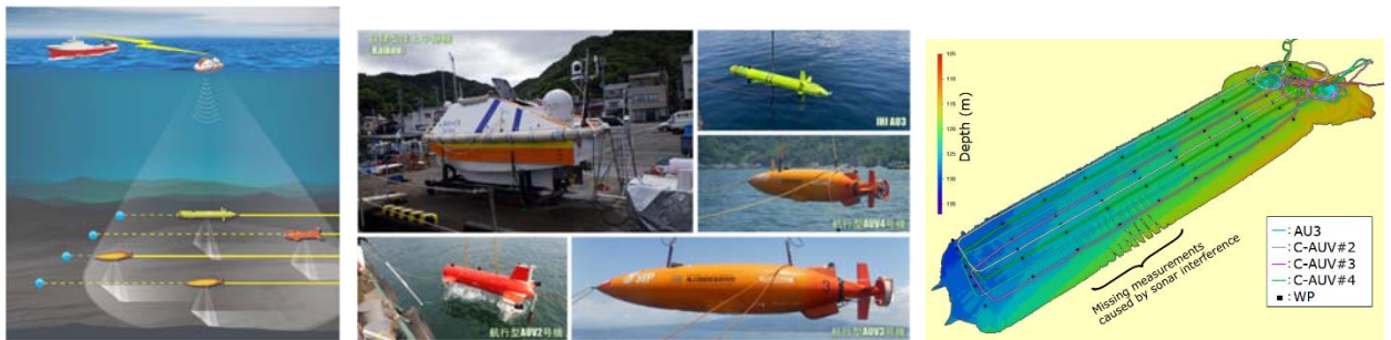
図1 基本隊列制御システムを用いた6月駿河湾での実海域試験 (5機のASV・AUVの試験概念図(左)、試験に配備されたASV・AUV(中)、取得した海底地形データ(右))
