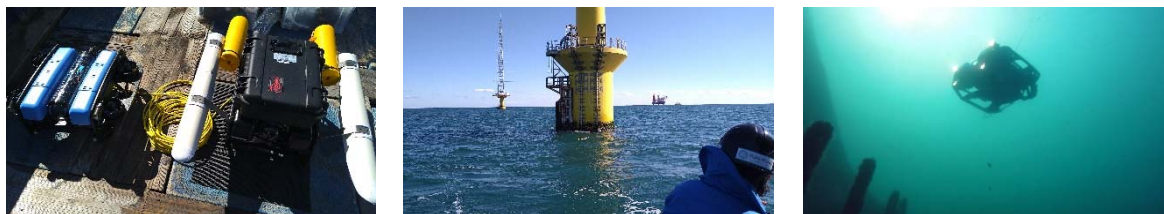
図7 銚子沖洋上風力発電設備での海中部点検技術試験の様子 (AUV-ASV 連結システム(左)、風車塔に接近した ASV を作業船から撮影(中)、海底付近の AUV(右))
