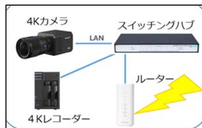
図 1.3.71 4K 高解像度カメラによる波浪モニタリングシステムの構築
