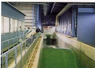
世界最大の波、3.5m の風波と最大 2.5m 相当の津波を起こすことができる大型の水路で、世界的にも希な実験施設です。特に、小さな模型実験では問題であった、地盤の動きや構造物の破壊過程についても、再現が可能です。
