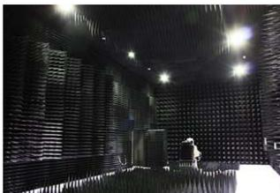
電子航法装置などの電波使用機器に対し、無限に広い空間と同じ環境条件を提供する施設です。特に、実験機器を屋外で実際に使用する前に、この中で電波を送受信する試験やアンテナの送受信特性を測定するために使用されます。
