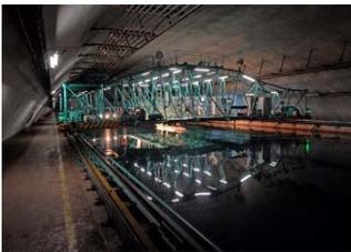
世界最大級の長さ 400m、幅 18m、水深 8mの曳航水槽で、非常に大きなプールで模型船を引っぱって性能を計測することで実船の性能を評価する実験施設です。特に、超高速船や大型模型船の試験にも対応が可能です。
