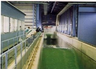
世界最大の波、3.5m の風波と最大 2.5m 相当の津波を起こすことができる大型の水路で、世界最大規模の実験施設です。特に、小さな模型実験では問題であった、地盤の動きや構造物の破壊過程についても、再現が可能です。
