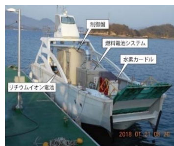
水素燃料電池システム及びリチウムイオン電池を搭載した小型実験船
