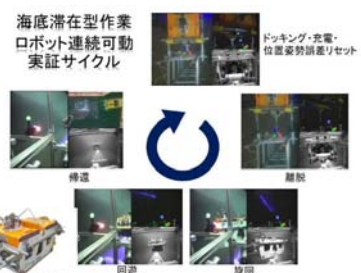
【AUVほばりんによるドッキング試験】
