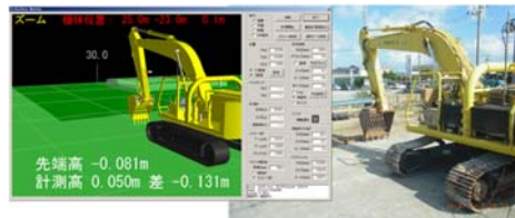
水中バックホウへのマシニング導入
