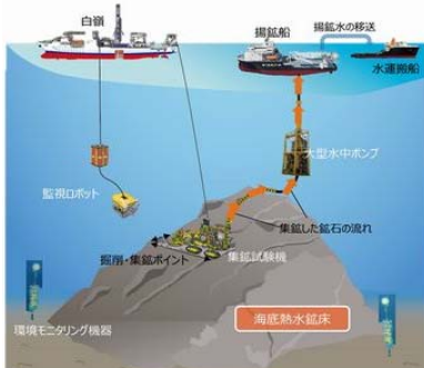
採鉱・揚鉱パイロット試験概念図(左)及び洋上に揚がった鉱石(右) (経済産業省ホームページより)
