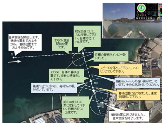
【着岸支援システムの音声ガイダンスの例】
