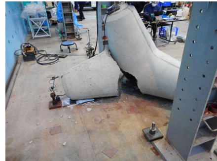
図 1.3.2b-6 消波ブロックの載荷試験
