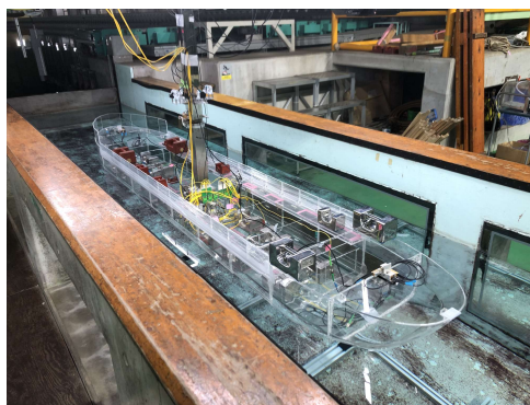
図 1.2.9 アクリル製弾性模型船(左)、及び線形計算と非線形計算のホギングモーメントの比(右)
