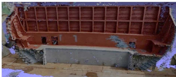
図 1.2.3 実船スケールの3D 形状生成結果
