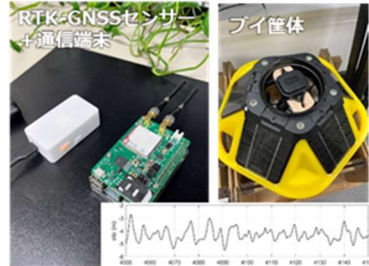
水位計測事例
