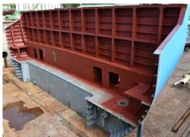
図 1.2.2 実船総組ブロック(写真)
