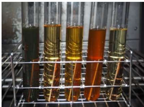
図 1.2.110 各種バイオ燃料 (金属腐食試験)
