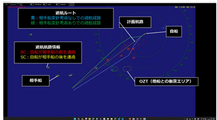
図 1.2.65 避航操船システム
