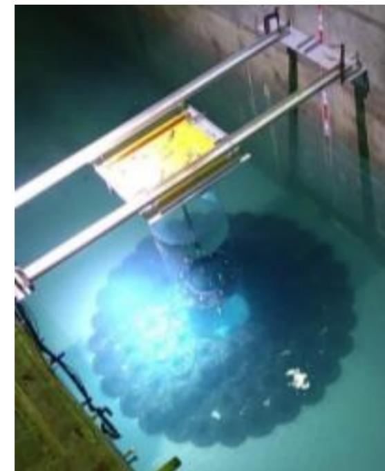
着床型洋上風力発電施設の大型洗掘試験
