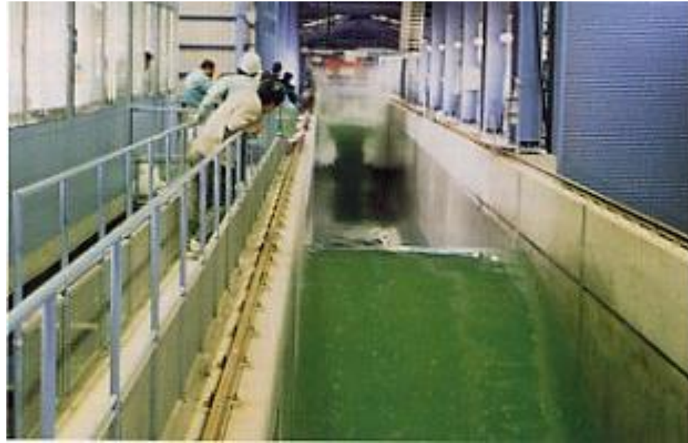
大規模波動地盤総合水路（高さ3.5mの波）
