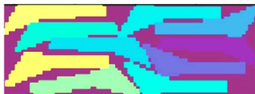
AIを用いたネスティング手法による 鋼板からの部材切り出し結果
