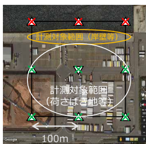
対空標識を用いた 港湾施設でのドローンによる計測
