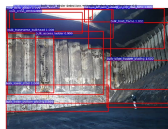
AIによる点検のための 船内の部材認識画像の例 海技研提供
