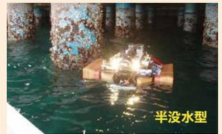
岸壁上部工下面の点検診断
